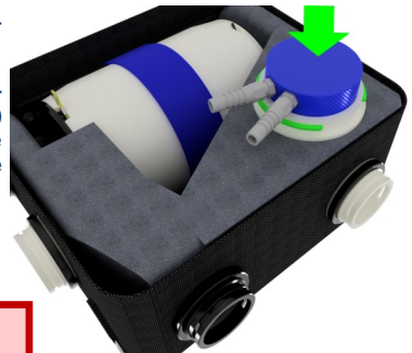
FIGURE 3.14 – connexion de l'électronique sur le faux-poumon inspiratoire.
