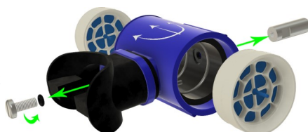
FIGURE 4.4 – Démontage du DSV de la boucle.
