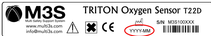
FIGURE 4.1 – Etiquette d'une cellule avec date de fabrication
