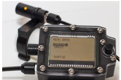
Lorsque la PPO2 mesurée reste dans la plage entre l'alarme haute et basse, le HUD n'allume aucune LED. Afin de savoir que tout fonctionne, on peut avoir un flash des 2 LED ponctuellement. C'est le **TEMPS HUD** (toutes les 2, 4, 6 ou 8 sec)
