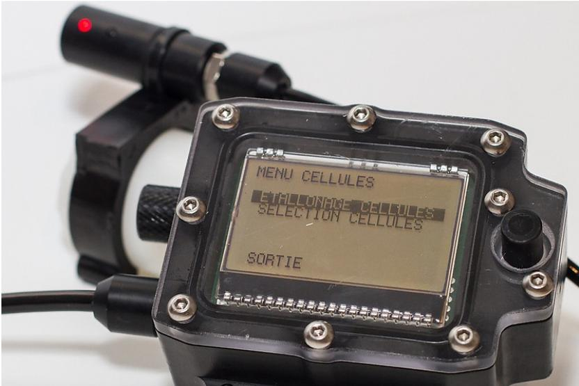
**SELECTION CELLULES** permet de paramétrer les cellules : choisir le type de cellules ainsi que leur nombre. Sur le Triton les valeurs par défaut sont : type générique, et 3 cellules.
