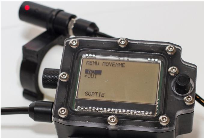
**LUMINOSITE** permet de choisir l'intensité de luminosité entre 25 % et 100 % par palier de 25 % .
