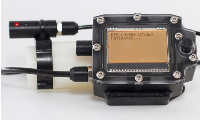
Une fois l'étalonnage terminé, le monox donne le résultat de chaque cellule avec la tension de celle ci. Il suffit de valider **Sauver/Sortir**
