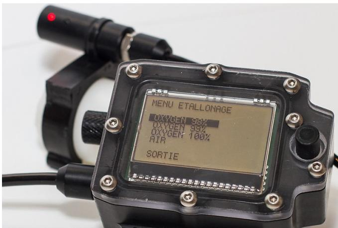
Une fois les cellules prêtes (dans le gaz choisi) on valide la ligne adéquat, et on choisit l'altitude à laquelle on se trouve.
