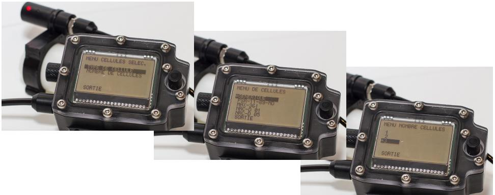
**ETALLONAGE CELLULES** permet d'étalonner les cellules à l'air, ou à l'oxygène et de choisir le pourcentage que l'on souhaite pour l'étalonnage oxygène (98 %, 99 % ou 100%)
